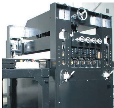
⑩ ロールレバラー (精密9本) 上下9本のローラーでパネル材の曲がりぐせを矯正します。
