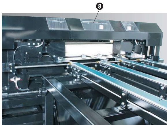
⑧ トリマー 集中操作盤で入力したパネル材の幅を自動位置決めしてスリットします。
