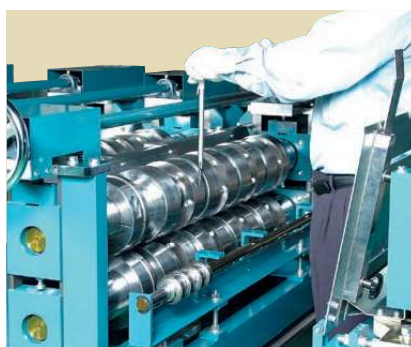
●スリッター丸刃の寸法合わせ作業は、オペレーターが機械の内部に行えるので、今までのように機械の上に乗っての作業は必要なく、安全・スピーディーに寸法合わせができます。
