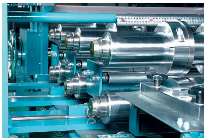
●スリッター丸刃(刃物ホルダー)を軸から取出すとき、片側の軸受けが移動するので、短時間で刃物交換ができます。
