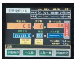
●操作盤は大型タッチパネル画面(160mm×120mm)の採用で、作業性・操作性に優れています。
