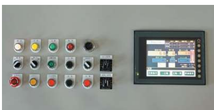
●操作盤は大型タッチパネル画面(160mm×120mm)の採用で、作業性・操作性に優れています。
