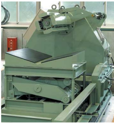
ピット内に設置したアンコイラー
