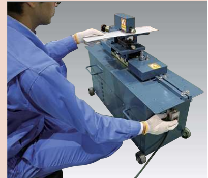
●兼用タイプのR折は、本体上部の駒で加工ができます。
