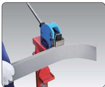
▲伸ばし作業による外曲げ
