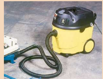
▲切断の際、発生する埃を吸い取る集塵機。
