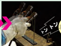
溶接棒で、母材を2回トントンと叩くか 電動工具のスイッチを2回ON-OFFする
