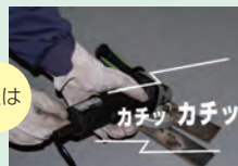
溶接棒で、母材を2回トントンと叩くか 電動工具のスイッチを2回ON-OFFする
