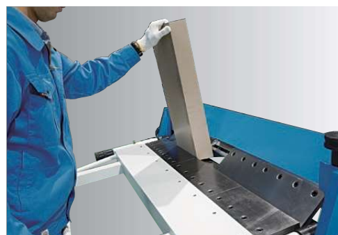
▲ 上刃の一部を外して箱折の段取。
