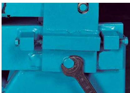
▲板厚に応じて下刃を基準に上刃の出し入れ調整 (LD-414) ※412はハンドル
