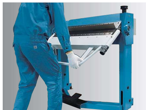
▲ 下ビームのハンドルを引き上げて曲加工します。
